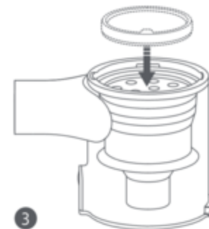
Фильтр предварительной очистки
